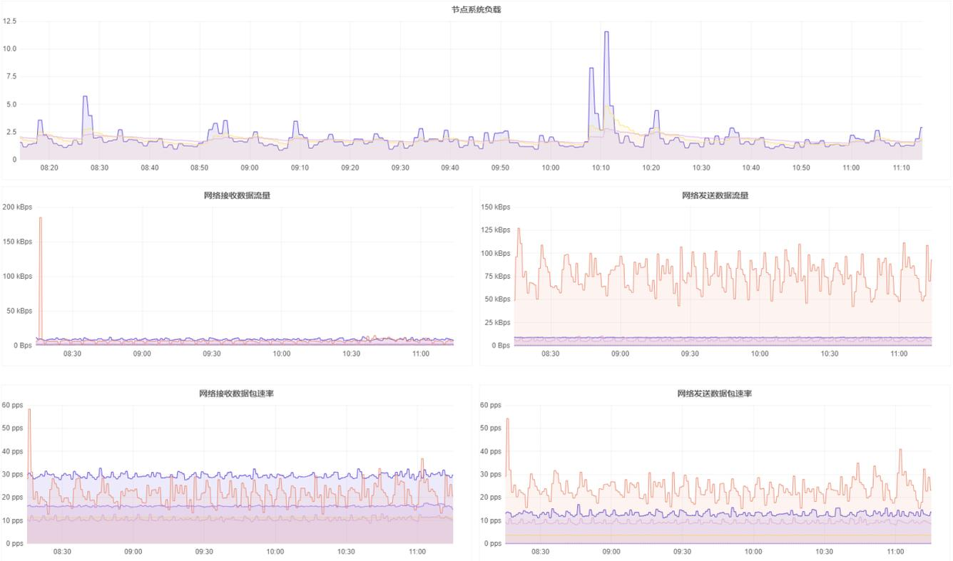
**节点系统负载：**节点系统负载是系统CPU繁忙程度的度量，即有多少进程在等待被CPU调度。图标左侧的数据单位是平均负载，即一段时间内系统的平均负载量，时间范围取1分钟、5分钟以及15分钟，您可以通过将鼠标移动到图表上方查看。
