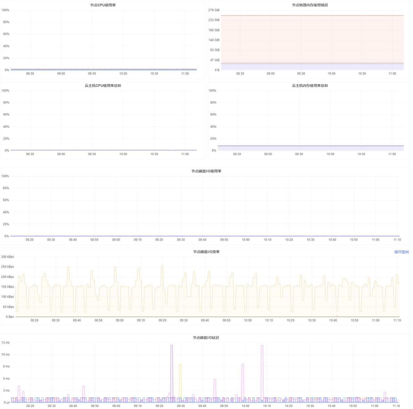
**节点CPU使用率：**在 **节点CPU使用率** 图表中，您可以清晰查看到当前CPU的使用率，当使用率超过70%时，会触发级别为 **警告** 的告警通知：节点 node-x:IP CPU使用率大于70%，当前为xx%。当节点CPU的使用率超过阈值90%时，会触发级别为 **严重** 的告警通知：节点 node-x:IP CPU使用率大于90%，当前为xx%。
