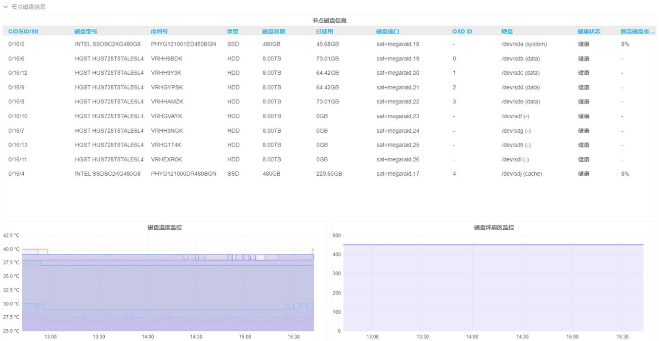
**节点磁盘信息列表：**在该表格中您可以查看到当前节点上所有的磁盘型号、序列号、磁盘类型、磁盘容量、磁盘使用量、磁盘接口、硬盘以及健康状态，对于SSD盘，您还可以直接查看到固态硬盘的损耗率。当节点机械硬盘出现故障，会触发级别为 **严重** 的告警通知：节点 node-x:IP机械硬盘xxxxxx疑似出现故障。当节点机械硬盘负载较高，会触发级别为 **严重** 的告警通知：节点 node-x:IP机械硬盘xxxxxx负载较高，如果是数据盘，可能出现慢盘故障。当节点固态硬盘寿命损耗严重时，会触发级别为 **严重** 的告警通知：节点 node-x:IP 固态硬盘xxxxxx寿命指标大于90%，当前为xx%。当节点磁盘脱落，会触发级别为 **严重** 的告警通知：节点 node-x:IP 硬盘xxxxxx脱落。
